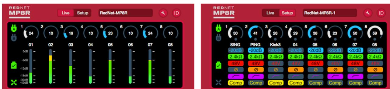
L'illustration ci-dessus montre l'image RedNet MP8R RedNet Control. Le niveau du signal, le gain et les réglages de la fonction d'entrée sont indiqués pour chaque canal. Utilisez les boutons Live et Setup en haut du graphique pour changer de vue.
